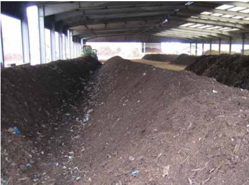
PRIZMAKOMPOSZTÁLÁS CSARNOKON BELÜL / WINDROW COMPOSTING IN A BUILDING
