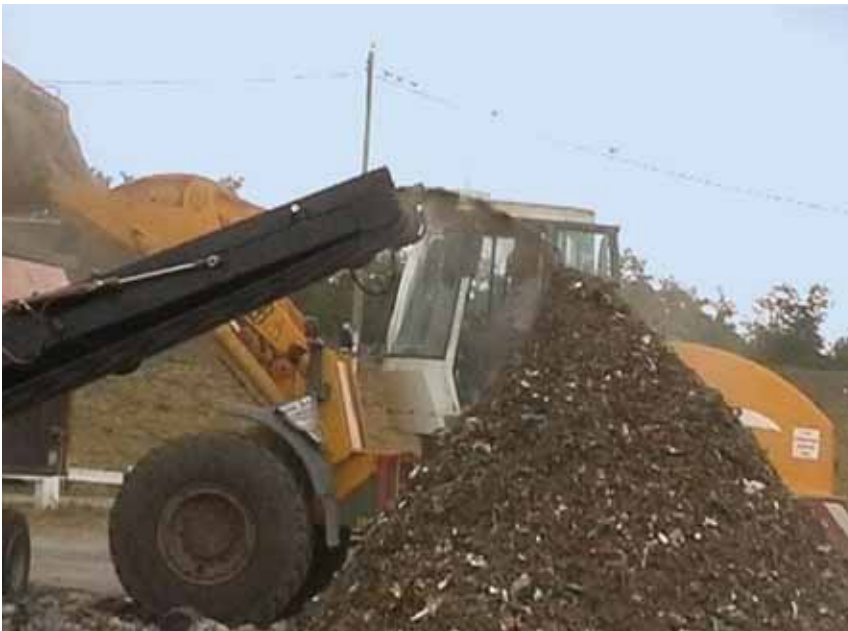
A KOMPOSZT-SZERŰ FRAKCIÓ KINYERÉSE ROSTÁLÁSSAL / EXTRACTION OF THE COMPOST-LIKE FRACTION VIA SCREENING
